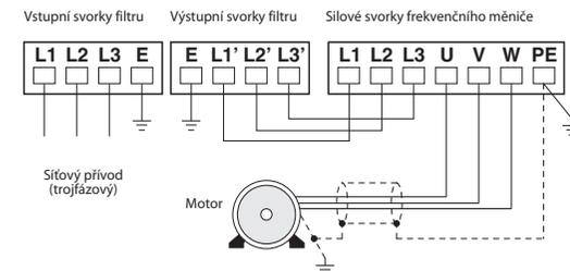
Všechny vodiče, zvláště pak vodiče mezi frekvenčním měničem a motorem, musí být s ohledem na rušivé vyzařování ve stíněném provedení. Stínění motorových vodičů je nutné na straně motoru a měniče uchytnit na velké ploše. Motor a odrušovací filtr je třeba dobře uzemnit. Dodržujte pokyny pro vnější vlivy a montážní polohu, které jsou uvedeny v návodu k obsluze frekvenčního měniče FR-E700 EC.
