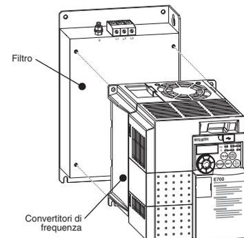
L'unità costituita dal filtro e dal convertitore di frequenza può essere quindi fissata con viti alla piastra di montaggio dell'armadio elettrico. Per ottenere un'azione ottimale del filtro, è necessario eseguire il collegamento conduttivo dell'alloggiamento del filtro e della piastra di montaggio collegata a terra. Questo si ottiene di norma fissando il filtro con viti alla piastra di montaggio. Rimuovere eventualmente la vernice dalla piastra di montaggio nei punti corrispondenti.
