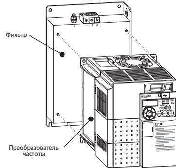
После этого блок, образованный из фильтра и преобразователя, крепится винтами на монтажной панели распределительного шкафа. Для достижения оптимального фильтрующего действия необходимо, чтобы корпус фильтра имел электропроводящее соединение с заземленной монтажной панелью. Как правило, это соединение образуется через винты крепления фильтра на монтажной панели. Если необходимо, удалите эмаль в соответствующих местах монтажной панели.
