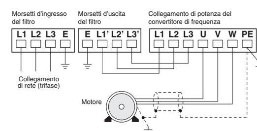
Tutti i conduttori, in particolare quello tra il convertitore di frequenza e il motore, devono essere schermati per ridurre i radiodisturbi. La schermatura del cavo del motore deve essere ampia sul lato del motore e sul lato del filtro. Deve essere garantita una buona conduzione a terra del motore e del filtro antiradiodisturbi. Per le condizioni ambientali e la posizione di installazione, seguire le indicazioni riportate nelle istruzioni per l'uso dei convertitori di frequenza FR-E700 EC.
