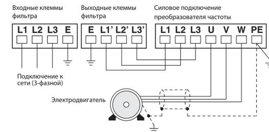
Для уменьшения помехозащиты все кабели (в частности, кабель между преобразователем частоты и двигателем) должны быть экранированы. Экран кабеля двигателя со стороны двигателя и со стороны фильтра следует наложить с как можно большей контактной поверхностью. Двигатель и помехоподавляющий фильтр следует заземлить с как можно меньшим сопротивлением. В отношении окружающих условий и местоположения соблюдать указания руководства по эксплуатации преобразователя частоты FR-E700 EC.
