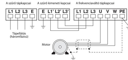
A kábel sugárzásának csökkentésére azokat árnyékolni és mindkét végükön földelni kell. Földelje a motort és kösse össze a szűrőkkel. A környezeti feltételeket és a felszerelési pozíciót illetően vegye figyelembe az FR-E700 EC frekvenciaváltó kezelési utasítását.
