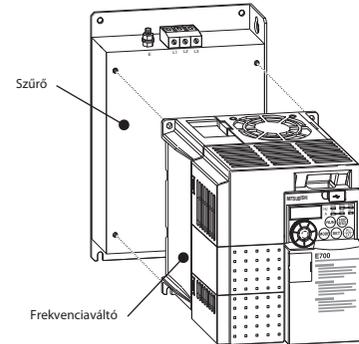
A szűrő-frekvenciaváltó egység szekrény hátuljára rögzítéséhez használja a szűrővel együtt szállított szerelőcsavarokat. A szűrő megfelelő teljesítőképességéhez a szűrő szerelőcsavarjait elektromosan össze kell kötni a szekrény földelt hátlapjával. Ha ez nem lehetséges, akkor a szűrő felfekvésének helyén el kell távolítani a festéket a szekrényről.
