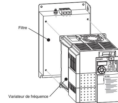
L'unité filtre et variateur de fréquence est ensuite vissée avec la plaque de montage de l'armoire de distribution. Il est nécessaire pour atteindre un résultat de filtrage optimal, que le carter du filtre antiparasite et la plaque de montage mise à la terre soient reliés électriquement. Ceci est en général obtenu en vissant le filtre et la plaque de montage. Le cas échéant, le vernis de la plaque de montage doit être enlevé à l'endroit correspondant.
