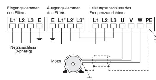
Alle Leitungen, insbesondere die Leitung zwischen Frequenzumrichter und Motor, sind zwecks Reduzierung der Funkstörung geschirmt auszuführen. Der Schirm der Motorleitung ist motor- und filterseitig großflächig aufzulegen. Motor und Funkentstörfilter sind gut leitend zu erden. Für die Umgebungsbedingungen und die Einbauposition sind die Hinweise in der Bedienungsanleitung zum Frequenzumrichter FR-E700 EC zu beachten.
