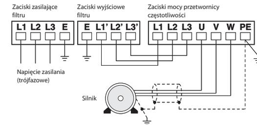
W celu zredukowania promieniowania kabla, należy wszystkie kable ekranować, a ekrany uziemić na obu końcach. Uziemienie silnika należy złączyć z filtrami. W sprawie warunków środowiskowych oraz pozycji montażowej prosimy zwrócić uwagę na wskazówki w instrukcji obsługi przetwornicy częstotliwości FR-E700 EC.
