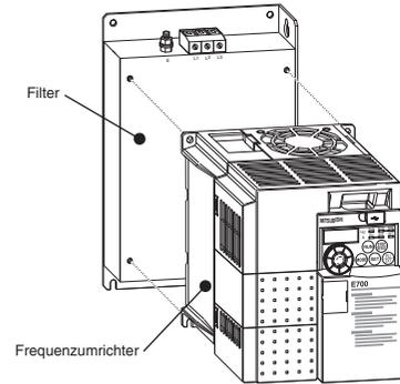
Die Einheit aus Filter und Frequenzumrichter wird nun mit der Montageplatte des Schaltschranks verschraubt. Um eine optimale Filterwirkung zu erzielen, ist es notwendig, dass das Gehäuse des Funkentstörfilters und die geerdete Montageplatte elektrisch leitend verbunden sind. Dies geschieht in der Regel durch das Verschrauben von Filter und Montageplatte. Gegebenenfalls ist die Lackierung der Montageplatte an den entsprechenden Stellen zu entfernen.
