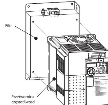
Zespół złożony z filtra i przetwornicy należy zamocować do pleców szafki rozdzielczej przy pomocy śrub montażowych, dostarczonych wraz z filtrem. Aby filtr mógł poprawnie funkcjonować, śruby montażowe powinny mieć dobry kontakt elektryczny z tylną płytą szafki, która połączona jest z uziemieniem. Jeśli nie jest to możliwe, należy usunąć farbę z obszaru bezpośredniego styku płyty montażowej z obudową filtru.
