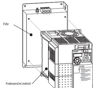
Komplet vytvořený z filtru a frekvenčního měniče se nyní přišroubuje na montážní desku rozváděče. K zajištění optimálního filtračního účinku je nutné, aby byl kryt odrušovacího filtru elektricky vodivé spojení s uzemněnou montážní deskou. Spojení je zpravidla zabezpečeno sešroubováním filtru a montážní desky. Případně je nutné na příslušných místech montážní desky odstranit lakování.
