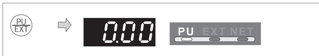
Если при "Управлении с панели" нажать клавишу "PU/EXT", происходит переключение на внешнее управление. В этом случае загорается индикация "EXT".
