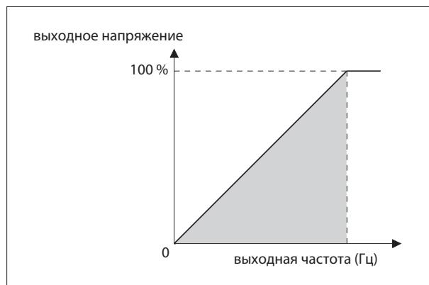
Параметр 3 устанавливает отношение между выходным напряжением и выходной частотой (характеристику U/f).
