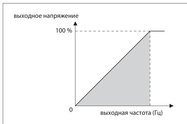
Изменяя выходное напряжение и частоту преобразователя частоты, можно бесступенчато изменять скорость вращения подключенного электродвигателя.
