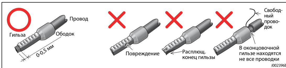
Рис. 2-30: Опрессовка оконцовочной гильзы
