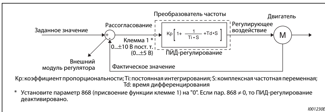
Рис. 5-159: Конфигурация системы для пар. 128 = 10, 11 (использование внешнего компаратора)
