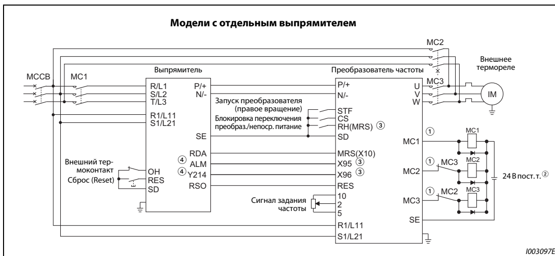
Рис. 5-146: Подключение силовых контакторов (модели с отдельным выпрямителем)
